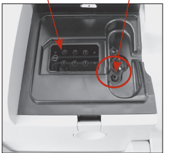
Figure 3 : Intérieur du compartiment de mesure des échantillons
