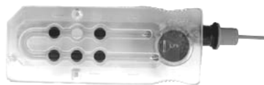
Figure F-4 : Cassette IDEXX VetStat avec adaptateur de seringue pour seringue Becton Dickinson 1-ml
