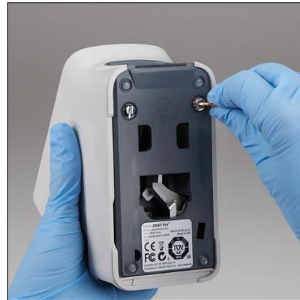
2. Sur la base de l'analyseur éteint, utilisez un tournevis à embout plat ou une pièce de monnaie pour tourner les 2 attaches argentées d'un quart de tour dans le sens contraire des aiguilles d'une montre.
