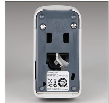
8. Assurez-vous que la base et les attaches argentées sont à niveau avec l'analyseur et qu'elles sont bien verrouillées. **Le fait de ne pas bien verrouiller la base et les attaches risque de nuire à la performance de l'analyseur.**
