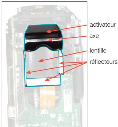
5. Nettoyez les 3 réflecteurs blancs, l'axe et l'activateur avec une nouvelle lingette non pelucheuse ou un nouveau cure-oreille imbibé d'alcool isopropylique à 70 %, d'eau et de savon liquide doux ou de solution à 10 % d'eau de javel. **NE NETTOYEZ PAS la lentille.**
