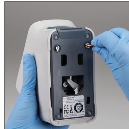
7. Tournez les attaches argentées d'un quart de tour dans le sens des aiguilles d'une montre pour bien les verrouiller.
