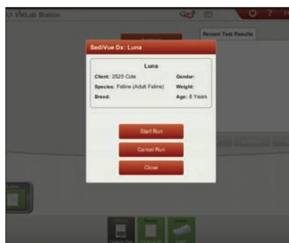
4. Fermez la porte de l'analyseur. Une fois que l'icône SediVue Dx a un statut vert « prêt », appuyez sur l'icône du patient sur l'écran d'accueil de la station IDEXX VetLab\* et appuyez sur **Démarrer analyse**. Une nouvelle cartouche sera placée dans la fenêtre de pipetage.
