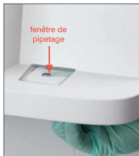
2. Ouvrez la porte de l'analyseur et nettoyez le haut et le bas de la fenêtre de pipetage avec une lingette optique humide. Essuyez ensuite avec une nouvelle lingette optique sèche.
