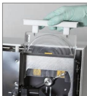
7. Retirez l'écran de protection de la centrifugeuse, la poubelle et le bac de récupération des liquides. Nettoyez-les ensuite avec de l'eau tiède et séchez-les avec du papier essuie-tout.
