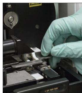
9. Remettez la poubelle, le bac de récupération des liquides, l'écran de protection de la centrifugeuse et le support à cartouches à leur emplacement dans l'analyseur.
