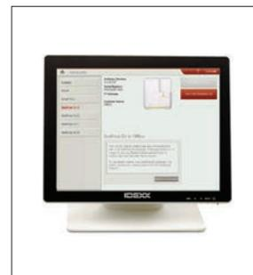
11. Sur l'écran des instruments de SediVue Dx, appuyez sur **Allumer SediVue Dx** pour mettre en marche le SediVue Dx.
