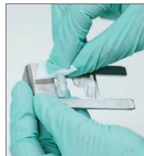
3. Retirez le support à cartouche, nettoyez-le avec un nouveau tampon d'alcool, séchez-le avec une nouvelle lingette optique sèche puis mettez-le de côté.
