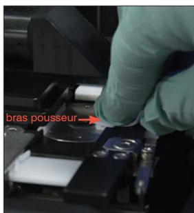
4. En utilisant un nouveau tampon d'alcool rincé, nettoyez le côté gauche du bras pousseur 5 fois (en veillant à ce que le bord droit de la piste soit minutieusement nettoyé), puis séchez-le avec une nouvelle lingette optique sèche.
