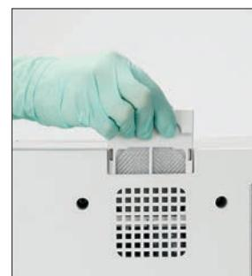
10. Retirez le filtre du ventilateur, rincez-le abondamment à l'eau tiède, tapotez-le avec du papier essuie-tout pour le sécher, puis remettez-le en place dans l'analyseur. Puis, sur l'écran du Guide de nettoyage de SediVue Dx, appuyez sur **Terminé** pour mettre en marche le SediVue Dx.
