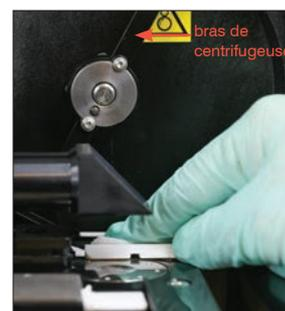
7. Déplacez délicatement le bras de centrifugeuse vers la gauche et inspectez la zone qui se trouve en dessous à la recherche de débris. Si elle est sale, utilisez un nouveau tampon d'alcool pour la nettoyer, puis séchez-la avec une nouvelle lingette optique.
