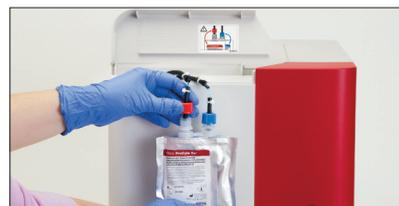
4. Placez le pack de colorants à la verticale dans le compartiment, en veillant à ce que les cordons soient devant le pack de colorants, à l'intérieur du compartiment, et à ce que les packs ne soient pas chiffonnés. Fermez ensuite le couvercle.
