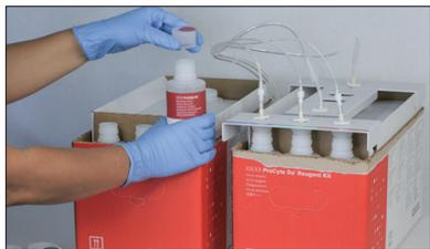
5. Placez la tête de connexion rapide sur le kit de réactifs, en vous assurant que les sondes sont bien insérées dans les 3 flacons de réactif, le diluant système et le compartiment à déchets.
