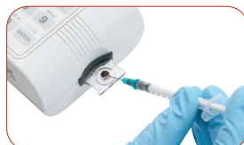
Figure 2 : ajouter l'échantillon au centre du puits
