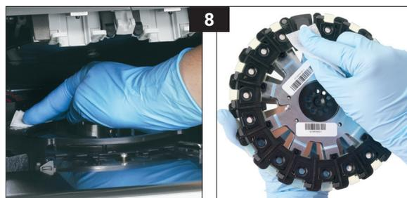
9. À l'aide d'une lingette optique propre, séchez les fenêtres optiques et ioniques ainsi que la surface de référence, en veillant à ce que toute trace d'humidité ait disparu des composants nettoyés. Si une quelconque trace d'humidité persiste, renouvelez la procédure de nettoyage.
