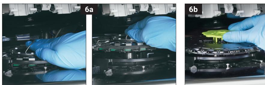
7. À l'aide d'une compresse alcoolisée validée par IDEXX, essuyez le rail du guide du plateau d'incubation dans le sens contraire des aiguilles d'une montre (n'essayez ni les composants optiques ni les fenêtres ioniques à cette étape). Répétez cette étape au moins trois fois, en changeant de lingette à chaque passage.
