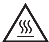
Attention, surface très chaude
