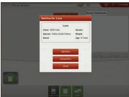
4. Fermez la porte de l'analyseur. Lorsque l'icône du dispositif SediVue Dx est de couleur verte et son état est « prêt », appuyez sur l'icône du patient sur l'écran d'accueil de la IDEXX VetLab\* Station et appuyez sur **Démarrer analyse**. Une nouvelle cartouche est placée dans la fenêtre de pipetage.
