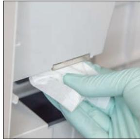
2. Ouvrez la porte de l'analyseur et nettoyez les parties supérieure et inférieure de la fenêtre de pipetage avec une lingette optique humectée d'eau tiède. Puis séchez-les avec une lingette optique.
