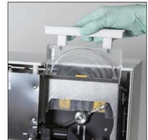
7. Retirez le dispositif de protection de la centrifugeuse, la poubelle et le bac récepteur. Puis nettoyez-les avec de l'eau tiède et séchez-les avec une lingette optique.
